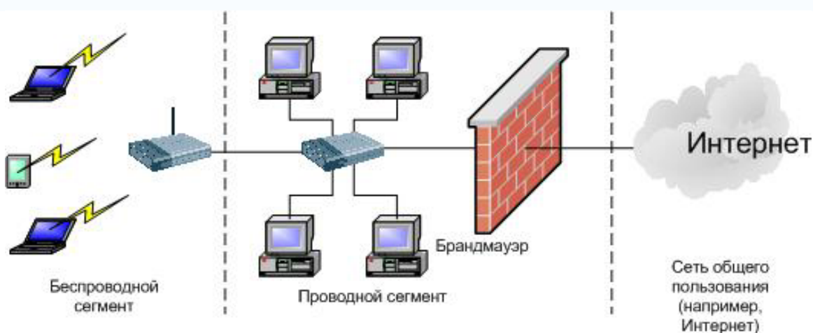
Рис. 1. Типовая схема организации беспроводной сети сегмента SOHO
